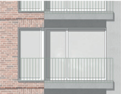
Offene Brüstung zum Park
