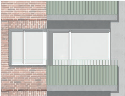
Offene Brüstung mit Sichtschutz zum Straßenraum
