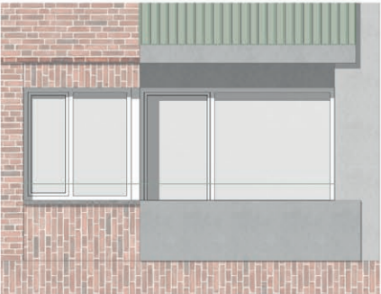
Massive Brüstung im Hochparterre
